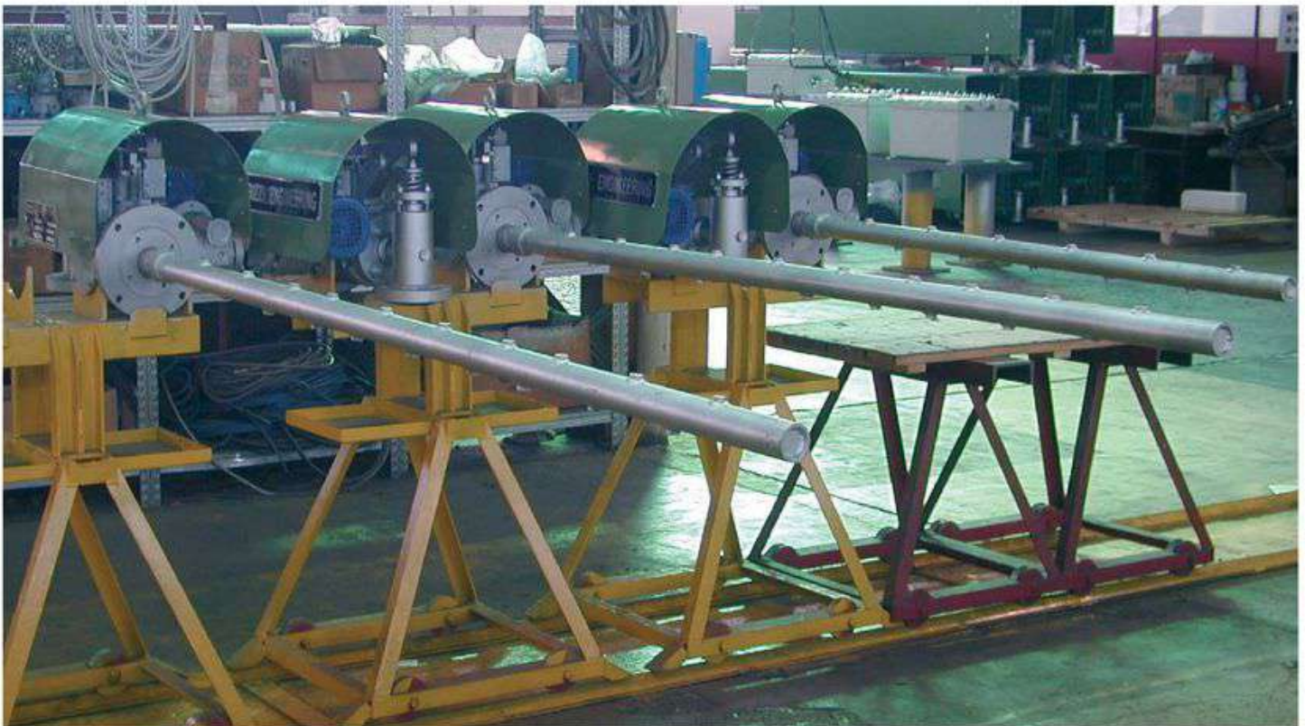
Soffiatori di fuliggine modello MU-VII a lancia rotativa in esecuzione antideflagrante.
