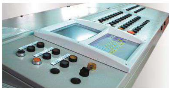
Simulatore per verifica quadri elettrici Simulator for control panel testing
